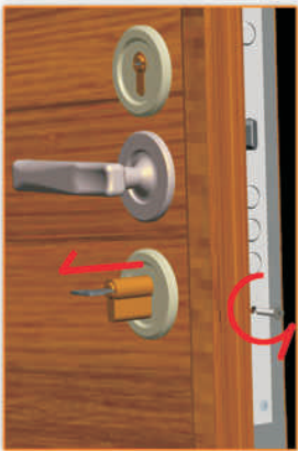
Kapıdaki eski silindir yıldız tornavida ile sökülür.
